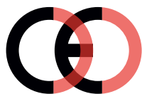
Falsk CE-mærke (for tæt på hinanden)
